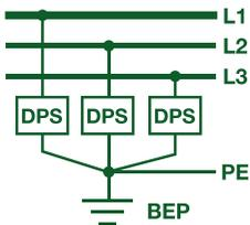
OBS; Luminária especial com entrada de tensão acima de 275VAC não possuem DPS interno neste caso deve se providenciar uma proteção maior na rede para à proteção e garantir a vida útil da luminária instalada. **Instalação que não estiver em conformidade a norma NBR-5410 pode acarretar na perda da garantia.**
