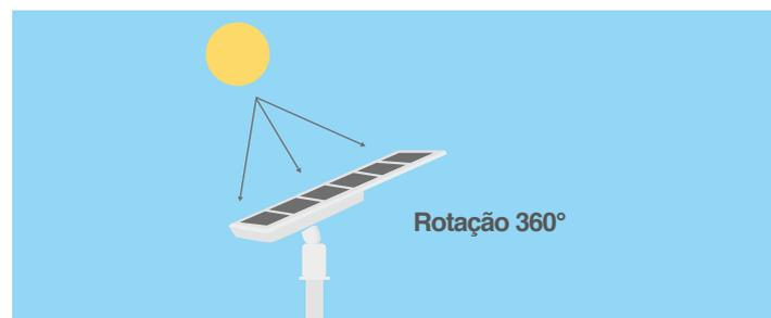
O ângulo de instalação pode ser ajustado para fazer com que os painéis solares fiquem de frente para o sol melhorando a eficiência da carga ao máximo.
