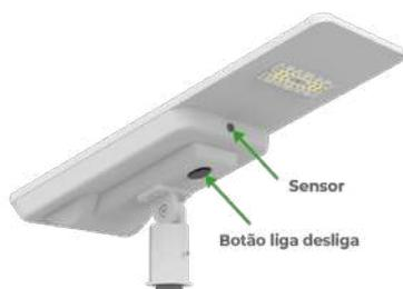
O botão liga/desliga vem desligado para conservar a carga da bateria no transporte, a bateria vem de fábrica com meia carga por motivo de segurança. Ao acionar o botão pode-se observar o LED vermelho interno do sensor que irá acender, a luminária acende automaticamente ao anoitecer e se apaga ao amanhecer, sendo dimerizada automaticamente através de sensor de movimento, para otimizar a autonomia do produto.
