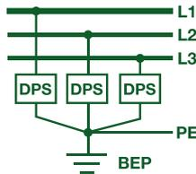
OBS; Luminária especial com entrada de tensão acima de 275VAC não possuem DPS interno neste caso deve se providenciar uma proteção maior na rede para a proteção e garantir a vida útil da luminária instalada. **Instalação que não estiver em conformidade a norma NBR-5410 pode acarretar na perda da garantia.**
