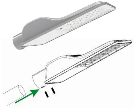
Montagem em poste ou braço com diâmetro de 48,50mm a 60,3mm. A sustentação é feita por dois parafusos localizados na parte superior da soqueteira. O torque de aperto nos parafusos é de no máximo 1,2Kgf.
