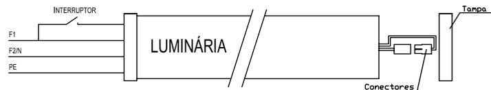
**Atenção:** Após ligar os conectores da bateria deve-se fechar a tampa apertando os parafusos com os devidos cuidados evitando o rompimento da vedação entre as partes, o torque recomendado para aperto da tampa é de 1N/m.
