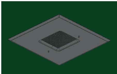
Após fazer a fixação da chapa metálica no forro, posicionar o projetor de LED nos furos e realizar a montagem, utilizando as porcas recartilhadas fazer o aperto e trava dos parafusos do suporte de fixação do projetor de LED realizando a junção com a chapa metálica.
