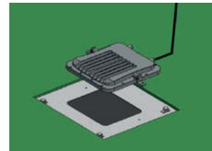
Posicionar a chapa metálica no local determinado do forro, fazer a fixação na estrutura do teto utilizando presilhas ou cabos de aço, prender nos suportes posicionados na face inferior da chapa.
